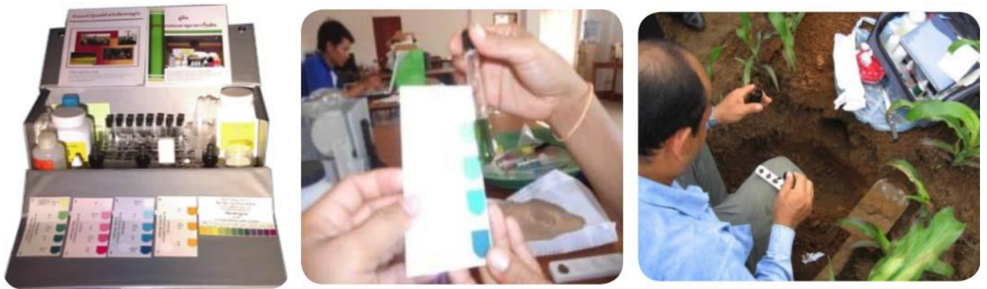
รูปที่ 19 การวิเคราะห์ดินโดยใช้ชุดตรวจวิเคราะห์ดิน
